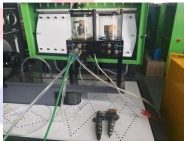
Se utiliza junto con un comprobador convencional para detectar inyectores CAT HEUI.
